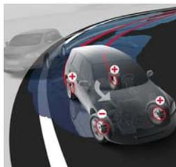
**VSC** interviene in modo mirato sui freni e sulla gestione del motore se rileva il rischio di sbandamento.
